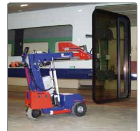
KS Robot 280 bei der Montage von Türen in ICE-Zügen.
