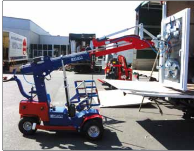
Abb. zeigt KS Robot 400 Offroad, 900 mm Teleskophub sorgt für eine hohe Ausladung bis zu 1.320 mm vor den Rädern.
