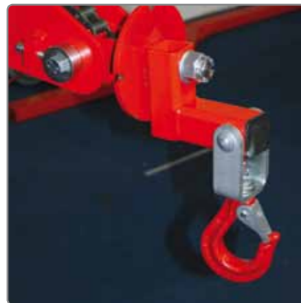
Der Kranhaken macht die Mehrfachnutzung, z.B. als reines Hebegerät möglich.
