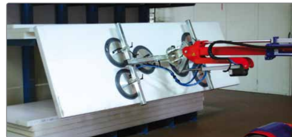
600 kg schwere Kunststoffplatten lassen sich aus dem Regal nehmen, auf dem Boden ablegen und Überkopf schwenken.
