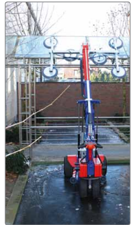
Ein besonders langer Teleskoparm macht den Einsatz auf großer Höhe möglich.
