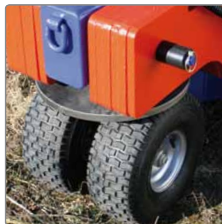
Die große Doppelbereifung hinten vermeidet das Einsinken auf nassen Böden.
